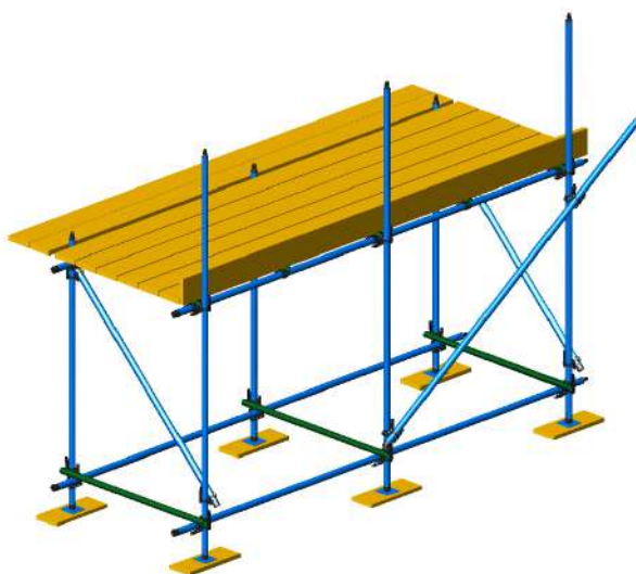
11. Monteer vloerplanken en kantplank.
